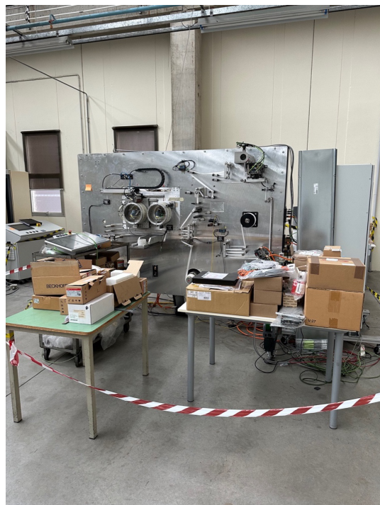
4 Macchina per test giunzione automatica bobina elettrica (A00530.53 test giunzione automatica bobina elettrodi)
