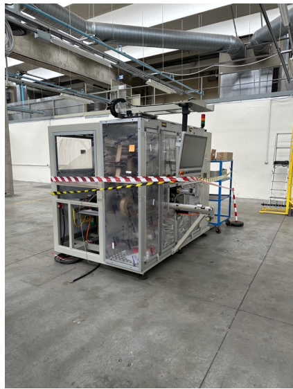
6 Macchina per avvolgitura batteria cilindrica (macchina finita) (A00530.16 Winding POC Lab Tool 4)
