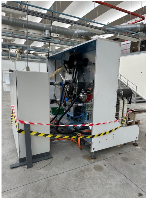
7 Macchina per test impilatura dinamica attiva (A00530.20 POC per test impilatura dinamica attiva)
