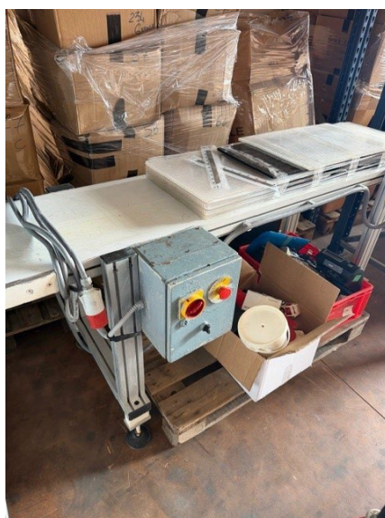
9 Nastro trasportatore industriale per uso alimentare, con tappeto bianco, struttura metallica su ruote e quadro elettrico di comando
