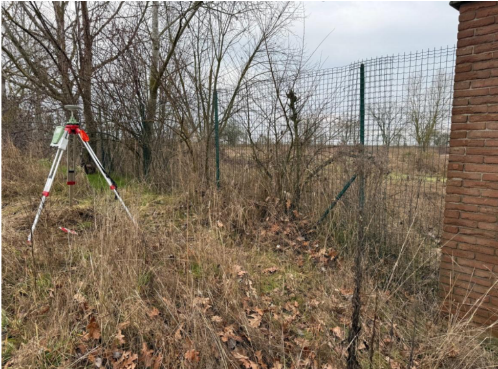
Foto 42 base stazione gps rilievo topografico
