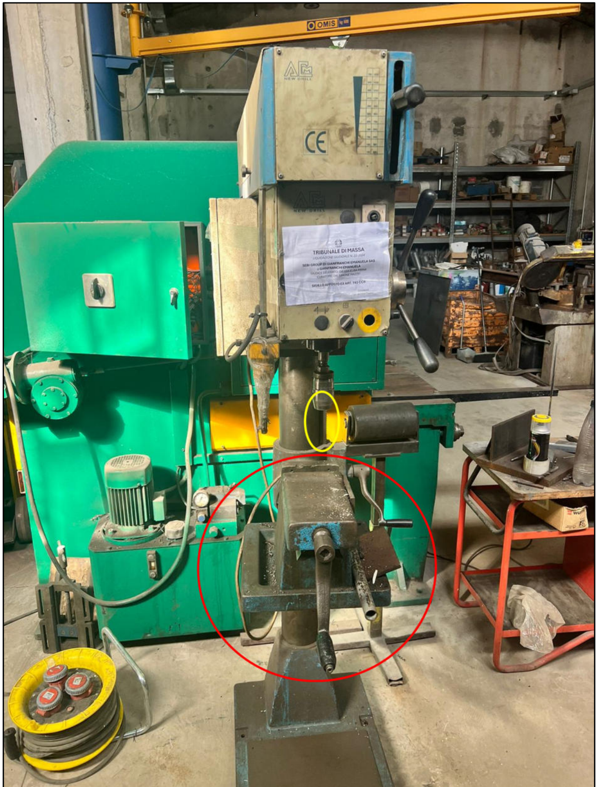
Figura 2. Fotografia scattata dal dott. Mazzei al momento dell'apposizione dei sigilli. Si noti l'assenza della punta e la tavola portapezzo rovesciata. Evidente poi l'assenza di trucioli sulla base si appoggio invece presenti il 11/10/2024.
