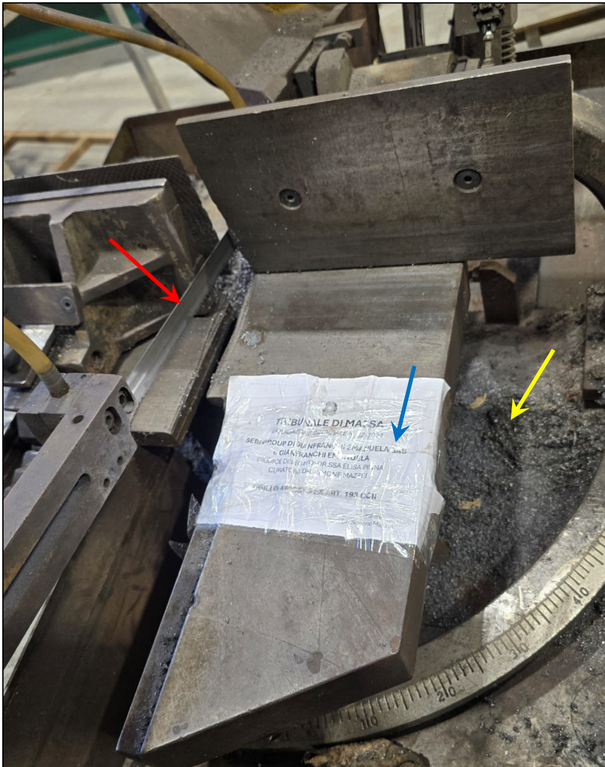
Figura 5. Fotografia scattata durante il sopralluogo del 11/10/2024. Si noti l'inclinazione del braccio di taglio e della lama (freccia rossa) diversa da quella rilevata dal dott. Mazzei (figura 6), la presenza di trucioli (freccia gialla), assenti il 21/08/2024, e la posizione della scritta SAS (freccia blu) diversa rispetto a quella visibile in figura 6.
