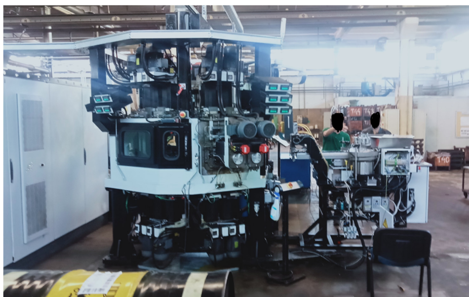
Figura 6 Foratrice multistazione CNC con caricatore.
