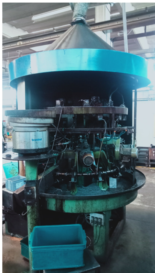
Figura 3 Esempio di foratrice usata in precedenza
