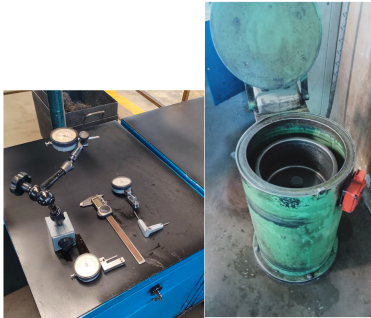
Figura 11 Strumenti mis vari e Centrifuga per recupero olio.
