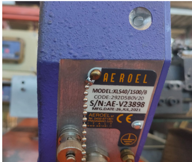
Figura 24 Targhetta del sistema laser di controllo dimensionale.
