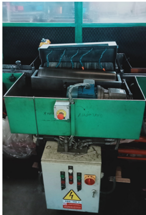
Figura 20 Stazione di lavaggio e asciugatura
