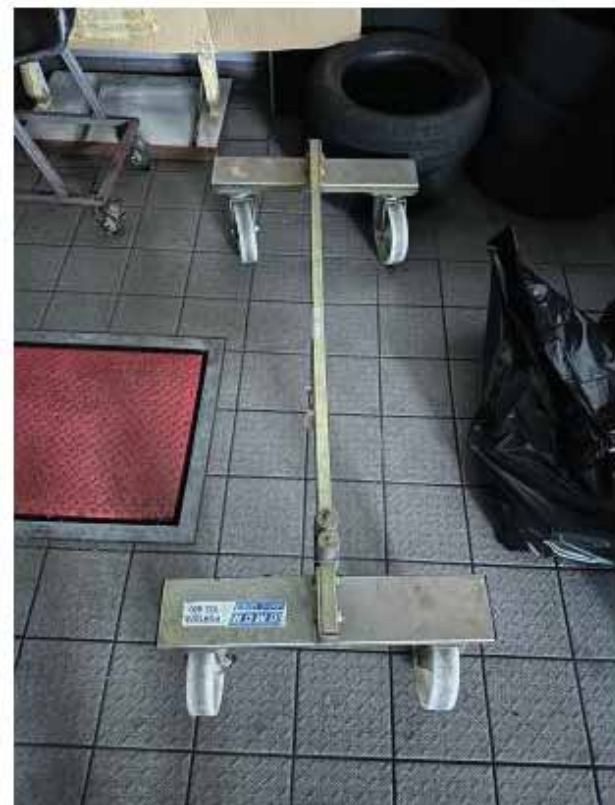
ID 0209 Carrello spostamento auto OMCN 250 portata 800kg
