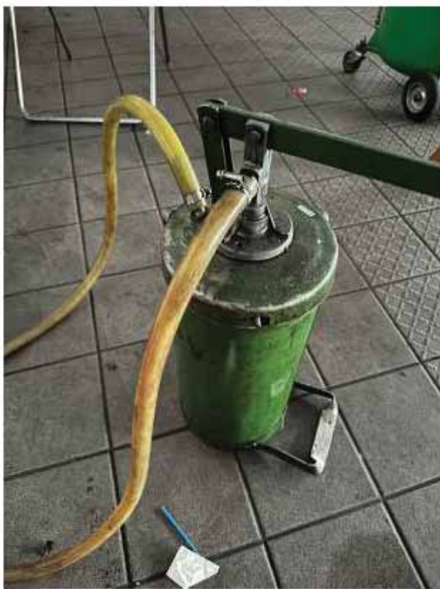
ID 0233 + 0234 Pompa travaso olio lubrificante LSD
