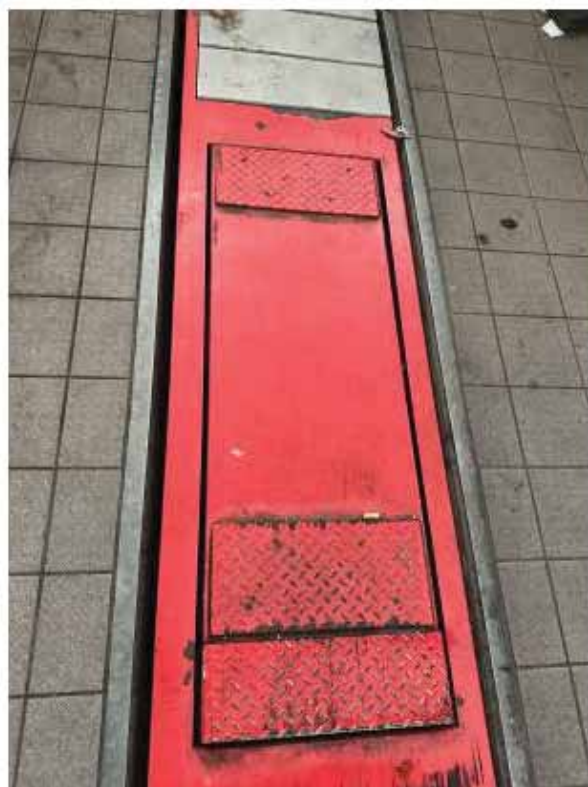
ID 0189 ponte a scomparsa completo di prova giochi Ravaglioli RAV 635.3 kg 3500 linea revis. MCTC
