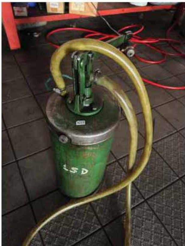
ID 0233 + 0234 Pompa travaso olio lubrificante LSD
