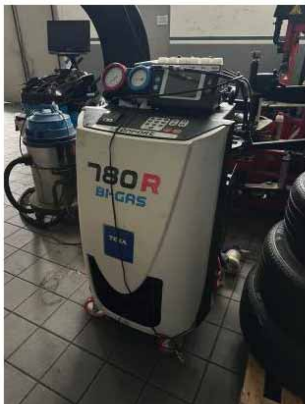
ID 0205 Stazione di diagnosi e ricarica aria condizionata Texa 780R BI-GAS
