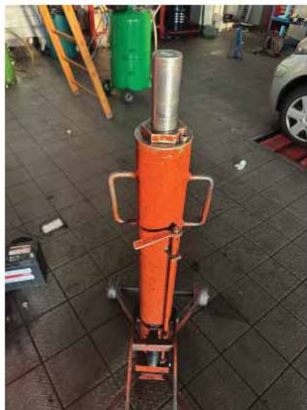
ID 0214 + 0215 sollevatore cambio con pompa a pedale con piastra e supporti meccanici
