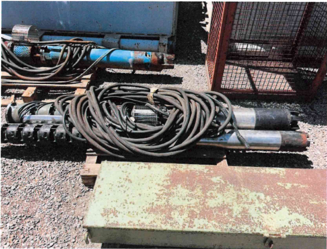
Foto 10 - Pompe sommerse con cavi
