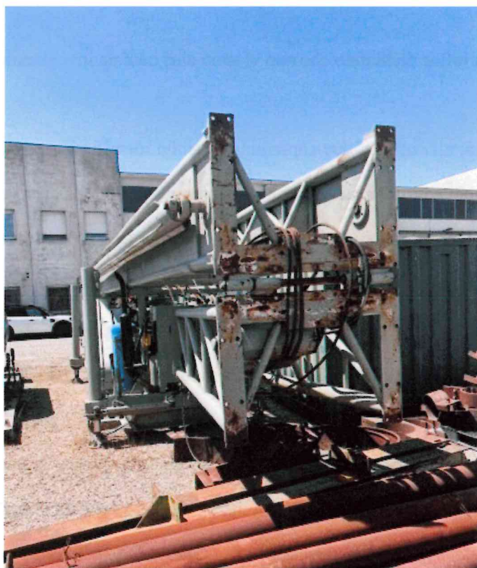
Foto 1— Torre di perforazione in posizione ripiegata, con cilindri idraulici di sollevamento e accumulatore: componente n. 1 (Massenza MPS 40).
