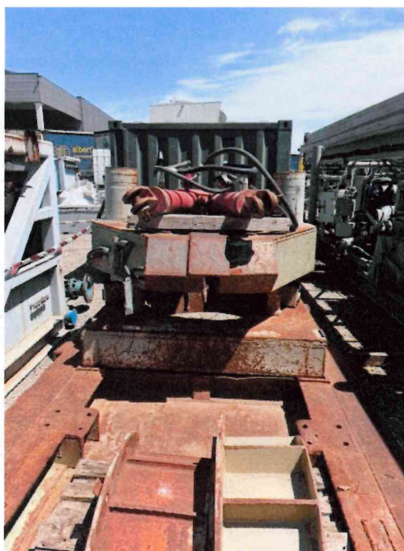
Foto 4 — Gruppo morsa/chave idraulica per manovra tubazioni (pipe tongs), montato su piastra girevole: componente n. 3 (Attrezzatura manovra tubazioni).
