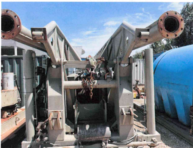
Foto 2 — Vista posteriore della torre di perforazione (mast) con giracolonni idraulico, tamburo argano principale con fune metallica e catena di manovra: componente n. 1 (Rig Massenza MPS 40).
