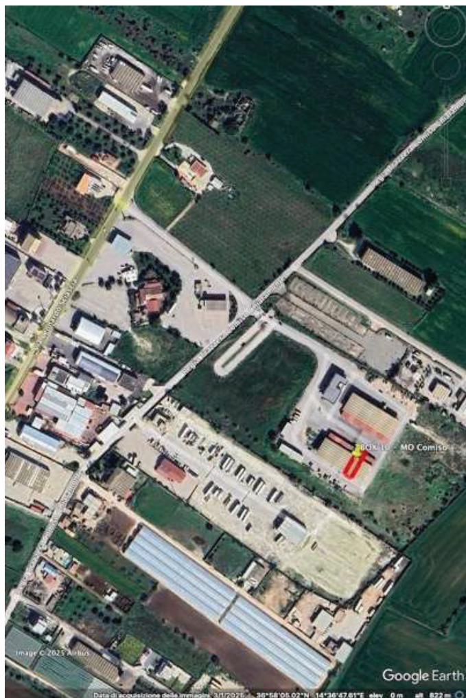
Foto 10 – foto aeree tratte da Google Earth al 23.06.2023 box 10 MO Comiso privo di pannelli ed al 01.03.2025 con n° 21 pannelli fotovoltaici per impianto fotovoltaico di 15 kW
