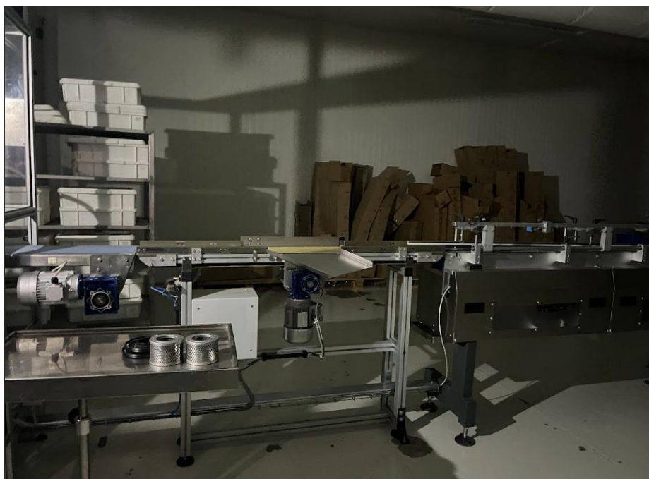
B.1 SISTEMA AUTOMATICO DI ALIMENTAZIONE CONFEZIONATRICE
